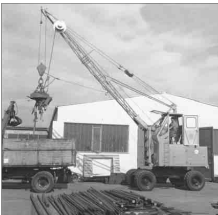
1962: S833 accionada por cable con cabina del conductor elevada
